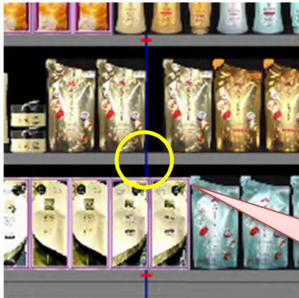
連結できる条件に合う棚板で、隣り合う棚板の「高さ」が一致している場合。本項(2)(3)の操作をすると自動的に連結されます。
